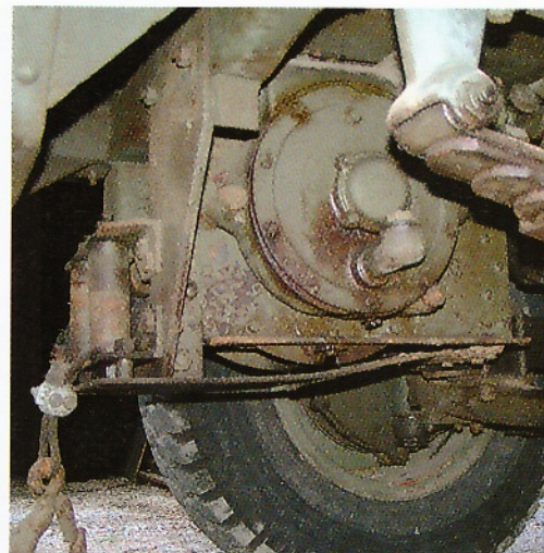
▲ Mekaanisen vinnin käyttämisessä tarvittiin kaksi miestä: toinen vetämässä vaijeria ja toinen ohjaamossa kytkemässä vetoa päälle ja pois.
