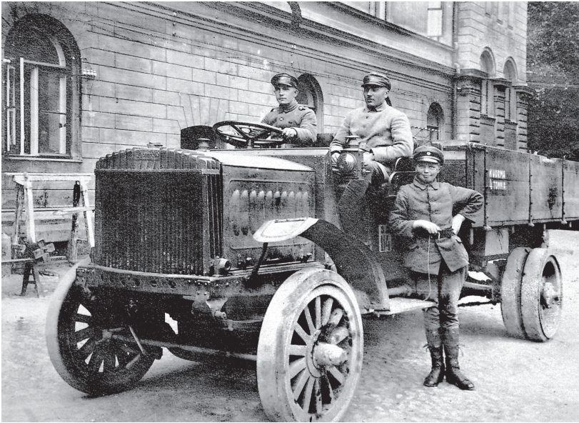
3-tonnin 4-syl. Locomobile-Riker -kuorma-auto 1914 (SA-11). Autosta puuttuu ajovalot ja avohyttikate. Näitä saatiin 6 kpl sotasaaliina.
