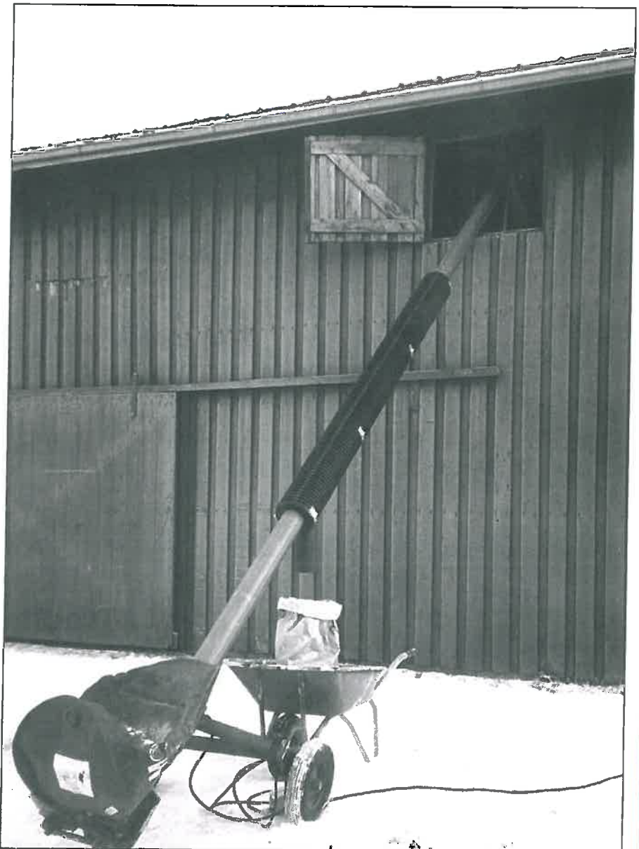
Ruuviseula asennetaan viljarsiirtoruvin keskelle. Muovisen kokoojaputken avulla rikat ja roskat saadaan koottua yhteen paikkaan. Kuva: Jouko Pelanteri
