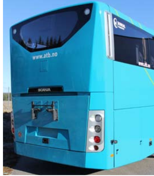
Korin taka-pään muodot ovat sileämmät kuin aikaisemmin, imuilman otto ylhäältä vasemmalta sivulasin korkeudelta ja kylkipelti on alumiinia.
