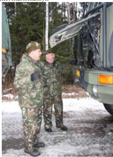
Tarkistetaan öljyn taso.
