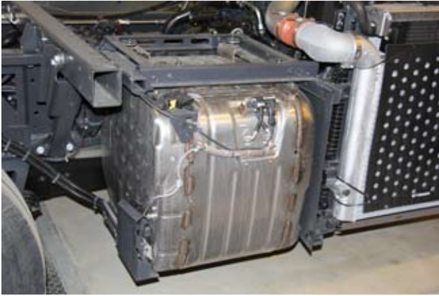
Äänenvaimennin pitää sisällään DOC:n, DPF:n SCR:n ja ASC:n. Ei ole siis ihan pelkkä pönttö.
