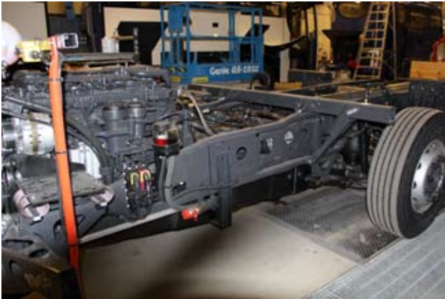
Teknisten osien mukana tuleva apurunkopalkki on hieman muuttunut Euro 6:n myötä. Ohjaustehostimen öljysäiliö on moottorin oikealla sivulla.
