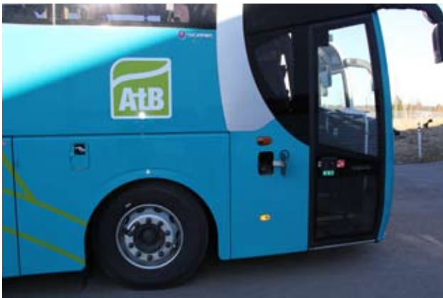
Polttoainesäiliön ja AdBlue -säiliön luukut ovat oikealla sivulla etupyörän eri puolilla, AdBlue edempänä. Kuvassa puuttuu vielä AdBlue -luukun merkintä, joksi tähän tule SCR.
