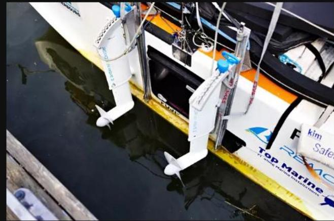
Global Solo Challenge -yksinpurjehduskisan osallistuneen Ari Känsäkosken veneen sähköä tuottavat vestiturbinit. Kuva: Outi Pyhäraanta / HS
