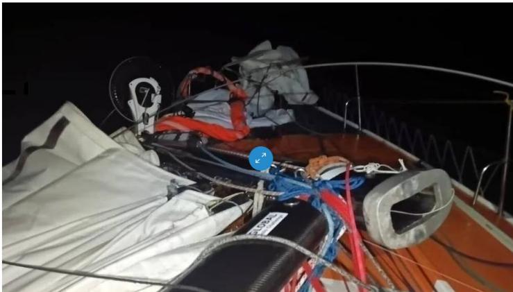
La rupture d'un des bas haubans est à l'origine du démâtage d'Ari Känsäkoski. "La tête pressée du rod au niveau de la cadène s'était détachée, malgré une inspection rigoureuse du gréement avant la Global Solo Challenge", explique l'organisation de course | ARI KÄNSÄKOSKI / GLOBAL SOLO CHALLENGE
