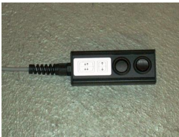
Kaukokäyttölaite keinukytkimellä ja 12 m:n kaapelilla (vakiovaruste)
