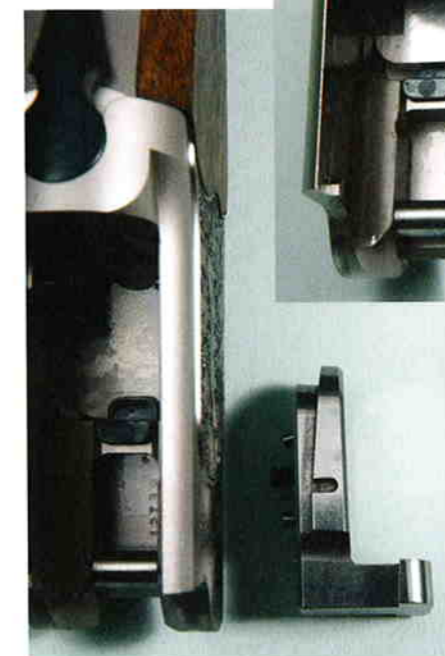
← ↑ Erinomaisen hyvin sovitettu ja luja keikkuva teräksinen sulkukappale aseesta irrotettuna, sulkuasennossa piippuparissa ja kehyksessä silloin kun piippupari on pois paikoiltaan.
