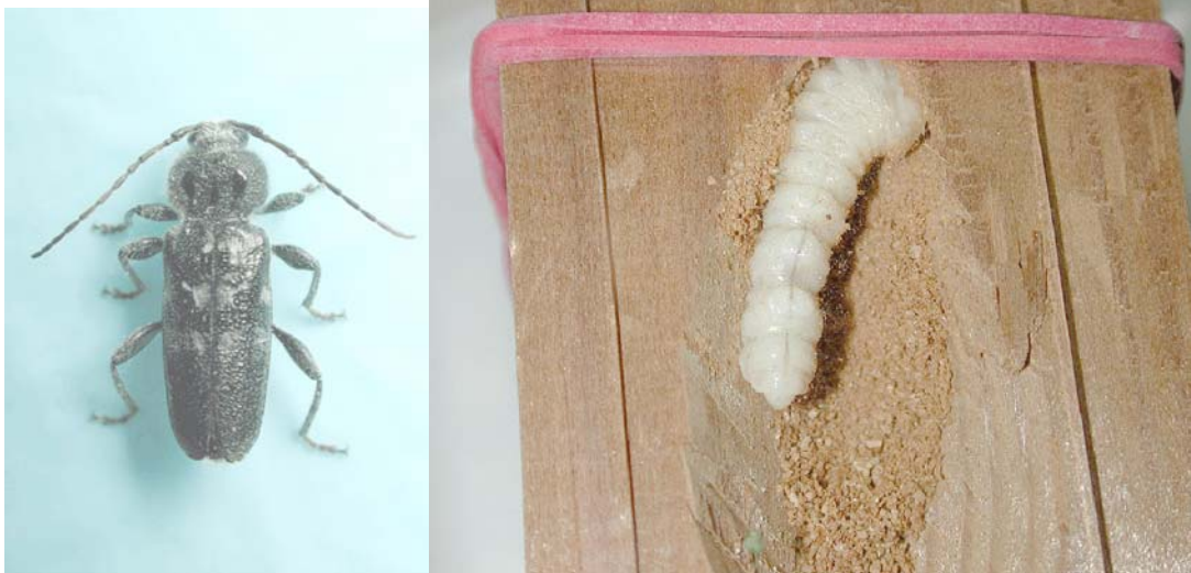
Abb. 14-4. Der Bockkäfer und die Larve im untersuchten Muster des wärmebehandelten Holzes (Foto von Jarmo Holopainen, Universität Kuopio).
