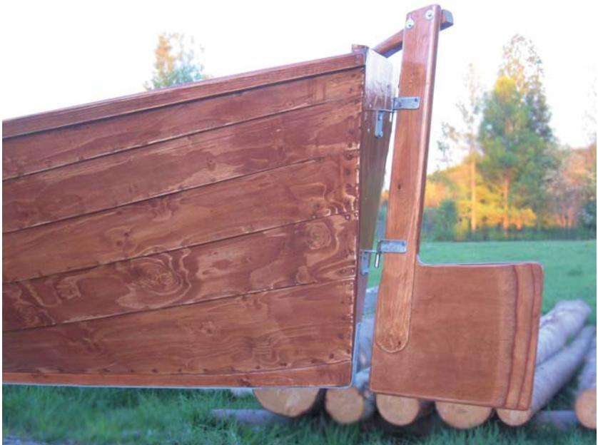
10. Peräsimen tulee olla puurakenteinen perään saranoin kiinnitetty.
