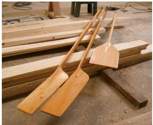
10. Aivot ovat puurakenteisia, vuorosoutumela on puurakenteinen ja yksilapainen. Melan lavassa sallitaan lasikuituinen tai muu vastaava vahviste.
