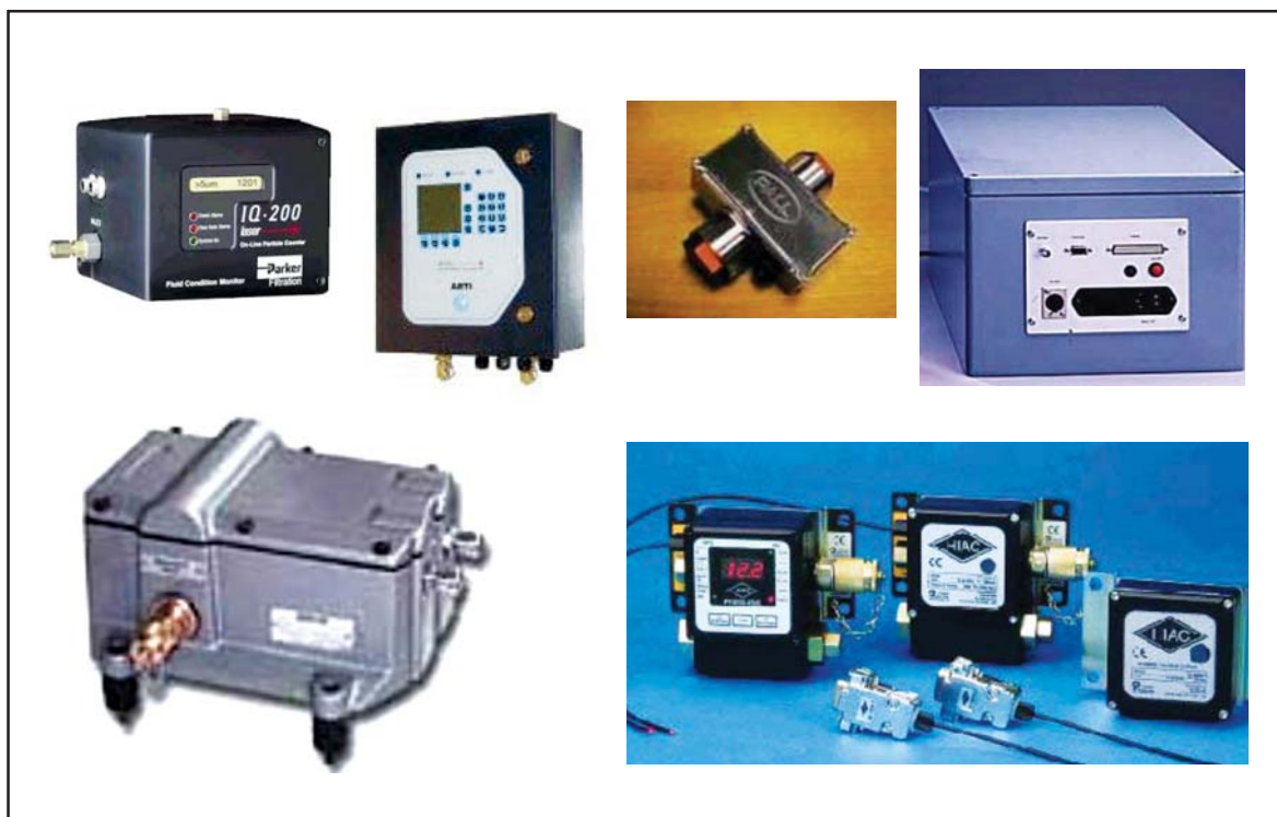
Kuva 3. Kiinteästi asennettavia hiukkaslaskimia käynninaikaiseen kunnonvalvontaan. Yläriivi vasemmalta Parkerin optinen in-line -hiukkaslaskin IQ200, Artin vastaava OPCO-laskin, Pallin PIM400 -hiukkaslaskimen anturi ja Pamas OLS in-line laskin. Alarivi vasemmalta Hydac CS 2000-sarjan optinen in-line -hiukkaslaskin ja HIAC PM4000 in-line -laskin [9-14].
