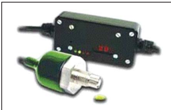
Kuva 2. Lubricard-anturi mittaa dielektristä häviökerrointa dielektrisyysvakion sijaan [6].
