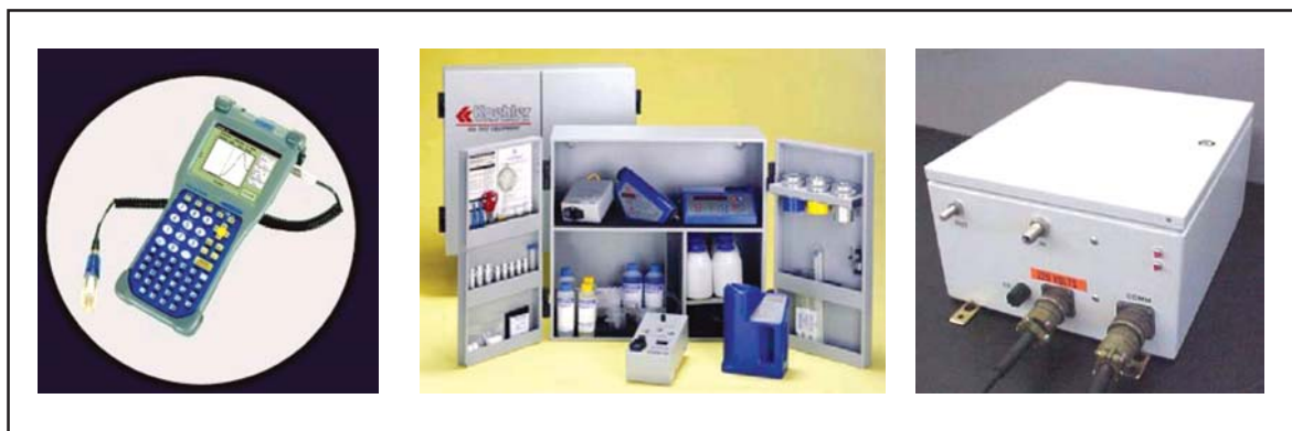
Kuva 9. Vasemmalta RULER CE320, kannettava öljyn TAN-luvun mittari, K86000 - räätälöity kenttämittaussetti öljyn kunnanvalvontaan, joka voi sisältää mm. veden määrän, tiheyden, viskositeetin, TBN- ja TAN-luvun sekä epäpuhtauksien mittavälineet, sekä Foster-Millerin valmistama FluidScan™ on-line oil analysis spectrometer [29-31].
