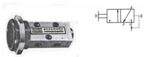
Kuva 7. Lihasohjattu, painepalautettu 3/2-suuntaventtiili. Toiminta-asento muutetaan painamalla venttiin päähän. (Atlas Copco)
