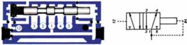
Kuva 25. Paineohjauksella, sisäisellä painepalautuksella varustettu venttiili. (Atlas Copco)
