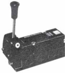
Kuva 10. Vipuohjattu 5/3-suuntaventtiili. Asentosalpa pitää venttiilin missä toiminta-asennossa tahansa. (Atlas Copco)
