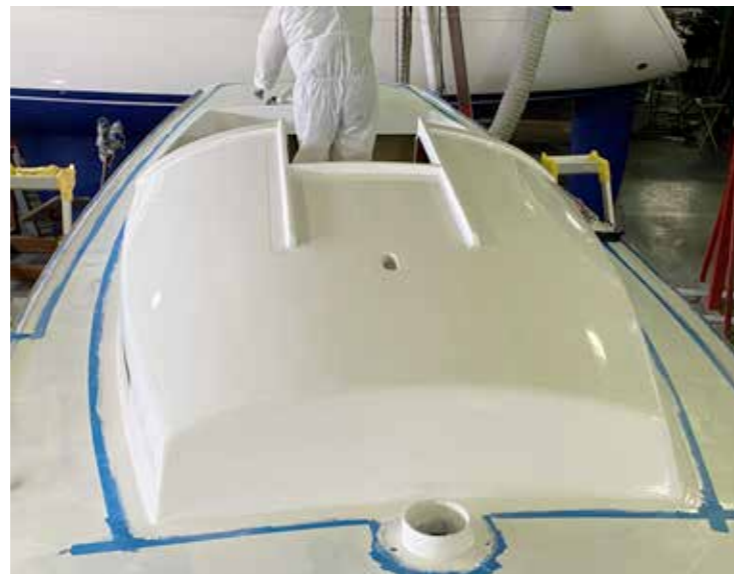
Kansi maalattiin karhealla liukastumisen estomaalilla ja ruffi sileällä tsetasoituvalla maalilla.
