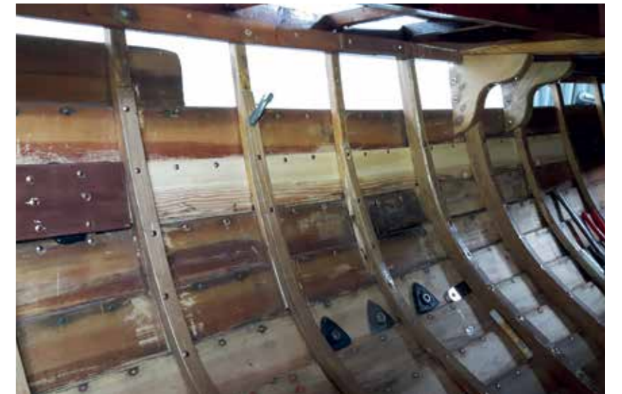
Kaari kiinnitetään niittaamalla.
