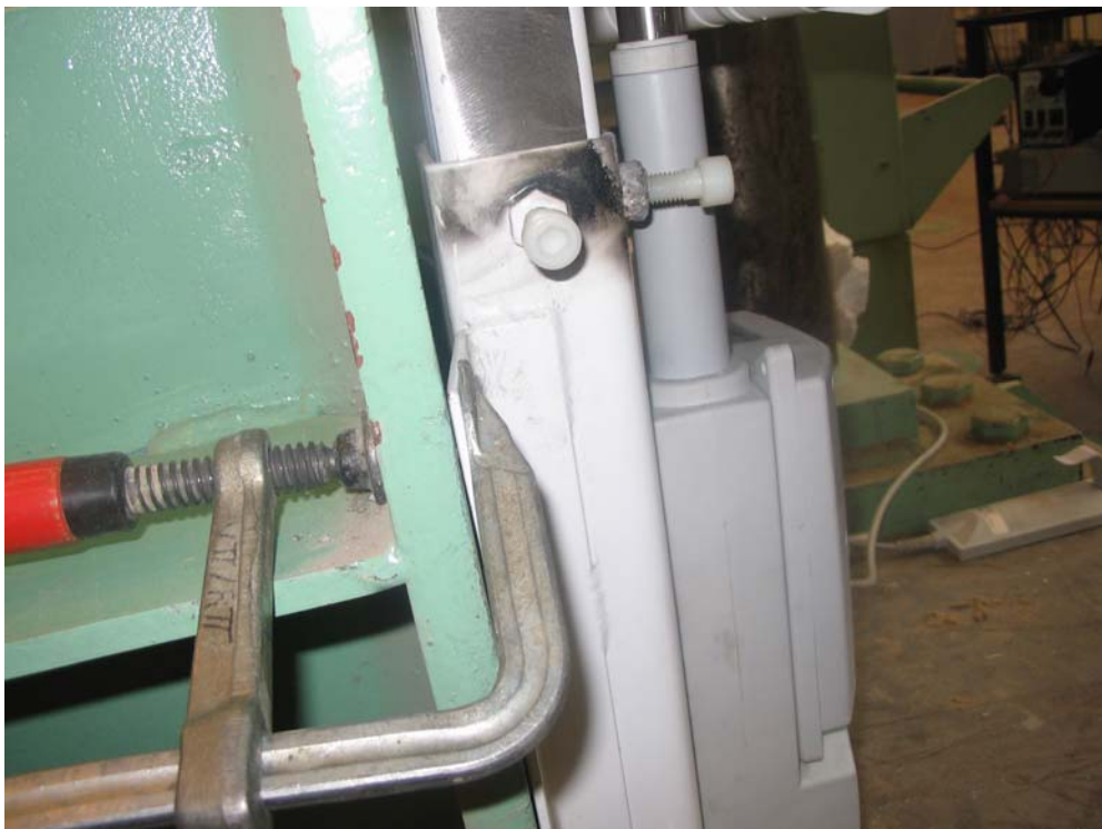
6. Ohut kiinnityslevy taipui ulos seinästä. Kiinnitys oli ruuvipuristimella pultinreikien kohdalta
