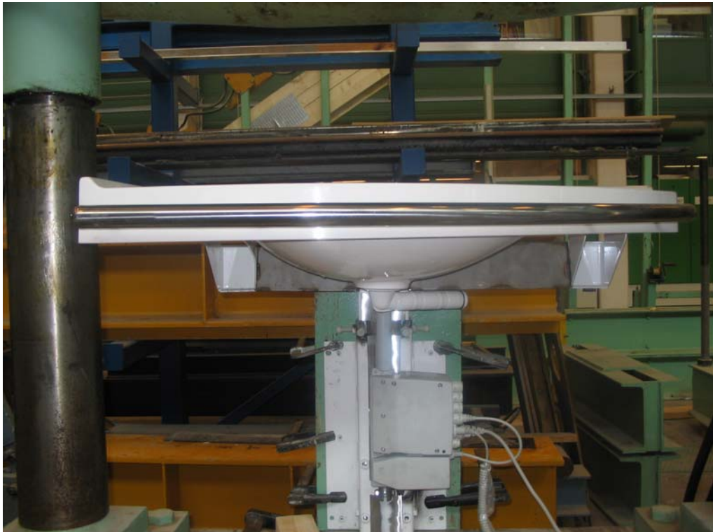
Kuva 4. Kaide kuormitusten jälkeen on edelleen vääntymättömänä altaan kyljessä
