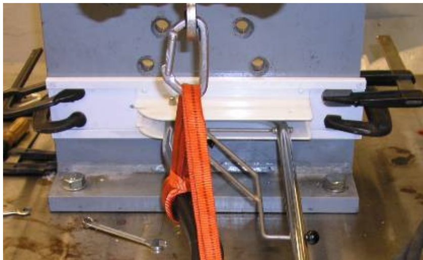
Kuva 1. Koekappaleen kiinnitys kokeessa 1.
