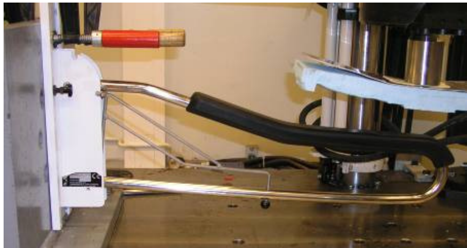
Kuva 5. Muodonmuutos kokeen 2 jälkeen
