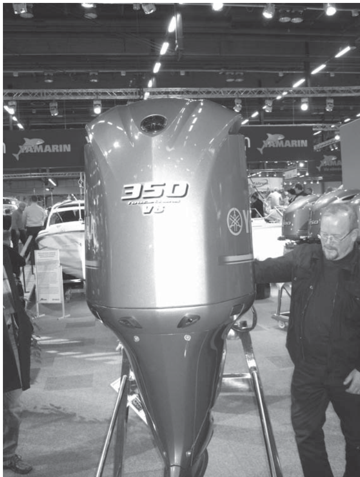
Tehoa löytyy. Kuvassa Yamahan 4-tahti sarjan 5,3 litrainen 350 hevosvoimaa kehittävä V8 moottori, painoa lähes 400 kiloa. (Helsinki)
