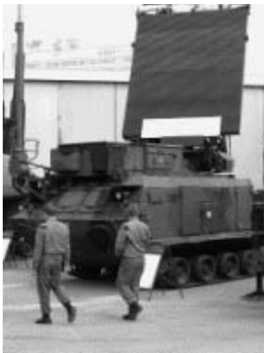
MOSTKA95, ITO96 järjestelmän valvontatutka ja MOSTKA87. IT -järjestelmien tehokkaimmat valvontasensorit.
