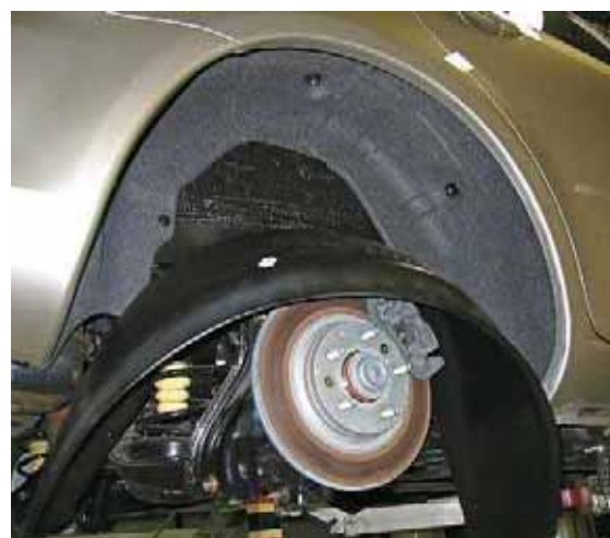
Hyvin suojattuun auton alustaan on ruiskutettu peittävä kerros suoja-ainetta pohjaan ja koteloinetta kaikkiin kotelorakenteisiin. Pyöräaukkoihin kannattaa hankkia muovilokarit, ellei autossa sellaisia jo ole.
