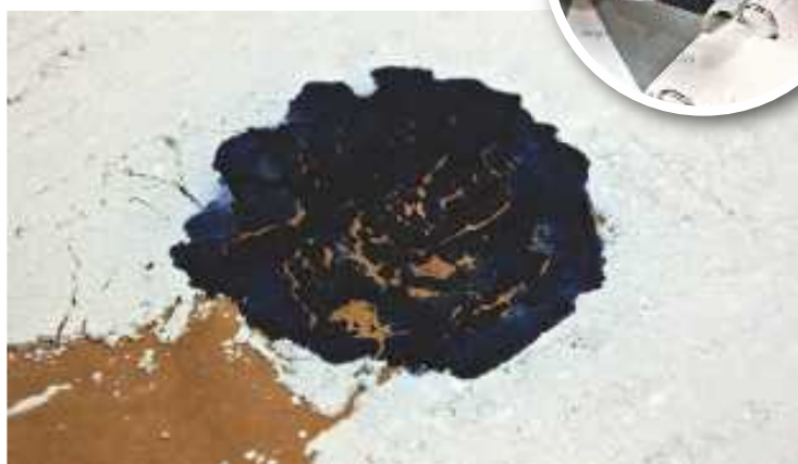
Vesipatsaskokeessa vuodot näkyvät armotta. Tomusokerin ja metyleenisen seos on todella herkkää kosteudelle. Pienistä hikoiluista ei vertailussa rangaistu, mutta kuvan kaltaiset selkeät vuodot johtivat hylkäykseen.
