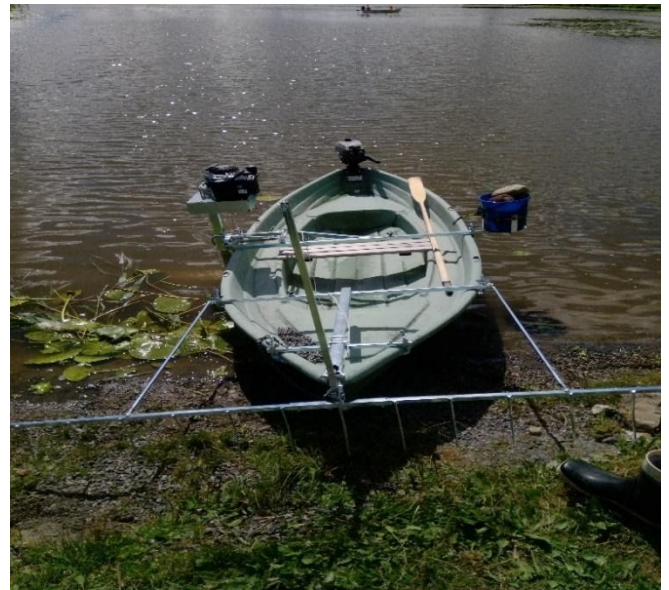
Kuvassa leikkuri lisävarusteineen asennettuna veneeseen, edessä kaislaharava.
