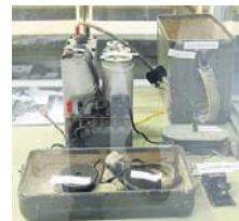
Kyynelradio mallia M4/75/7 (sisältää lähettimen ja vastaanottimen)
