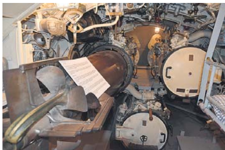
Vesikon aseistuksen kolme torpedoputkea.
