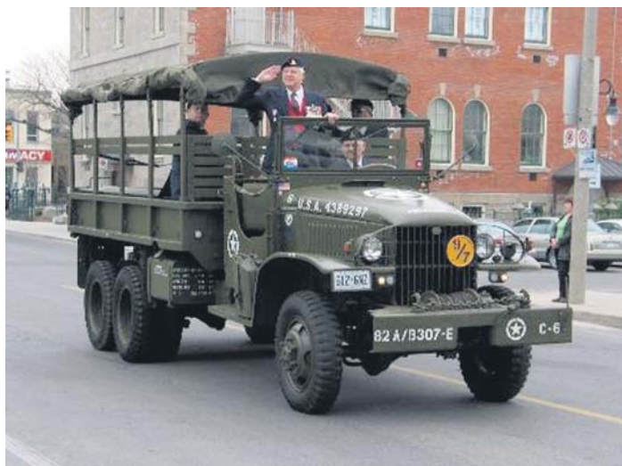
Neuvostoliittoon toimitetuista n.400 000 sotakuorma-autosta suurin osa oli kolmiakselisia, kaikilla pyörillä vetäviä ja etuvivassilla varustettuja (6x6). GMC-kuorma-auto oli tuttu näky Suomenkin maanteillä sodan jälkeen.
