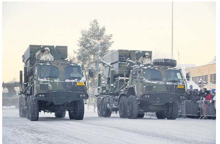
Maalinosoitustutka, jota käytetään ilmatilannekuvan täydentämiseen.
