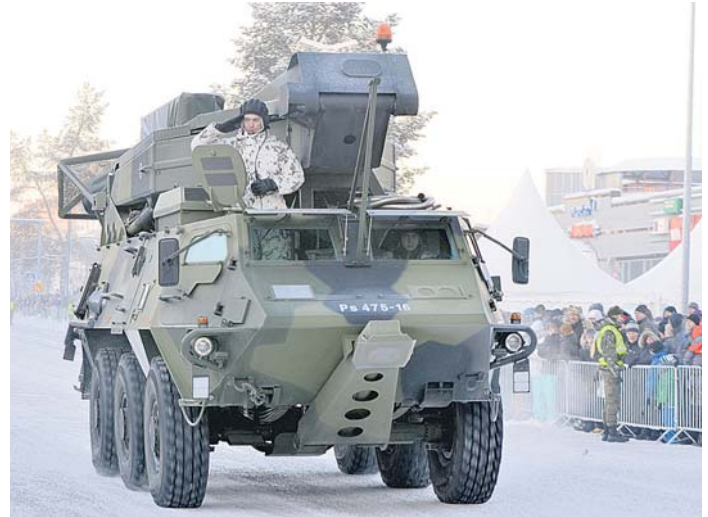
Maalinosoitustutka, jota käytetään ilmatilannekuvan täydentämiseen.
