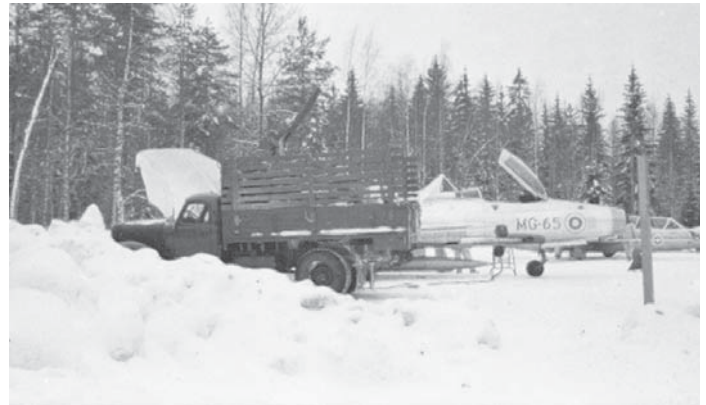
Kiitotien pään seisonta-alueella mg-65 saa käynnistysvirtaa akkuautosta, kaapeli koneen alla. Takana vieraileva fougamagister harjoituskone,
