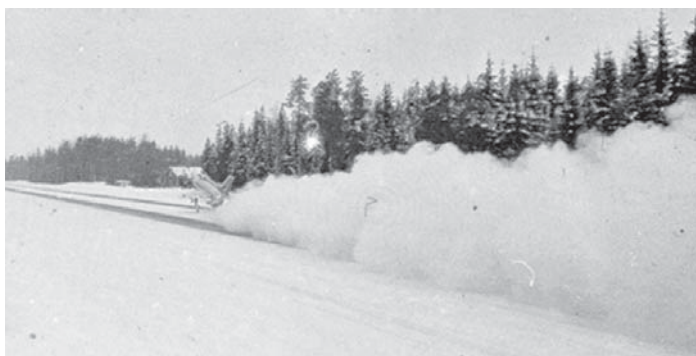
Startissa lumi pölysi. Tien pinta oli jäinen ja luminen. Koskaan aikaisemmin ei MG:llä oltu lennetty talvella maantieltä. Ohjeen mukaan startissa jarrut päällä täydet tehot ja vasta sen jälkeen jarrut irti. Liukkauden takia kone lähti liukuun, joten oli muutettava ohje. Täydet tehot päälle vasta koneen ollessa jo liikkeellä.
