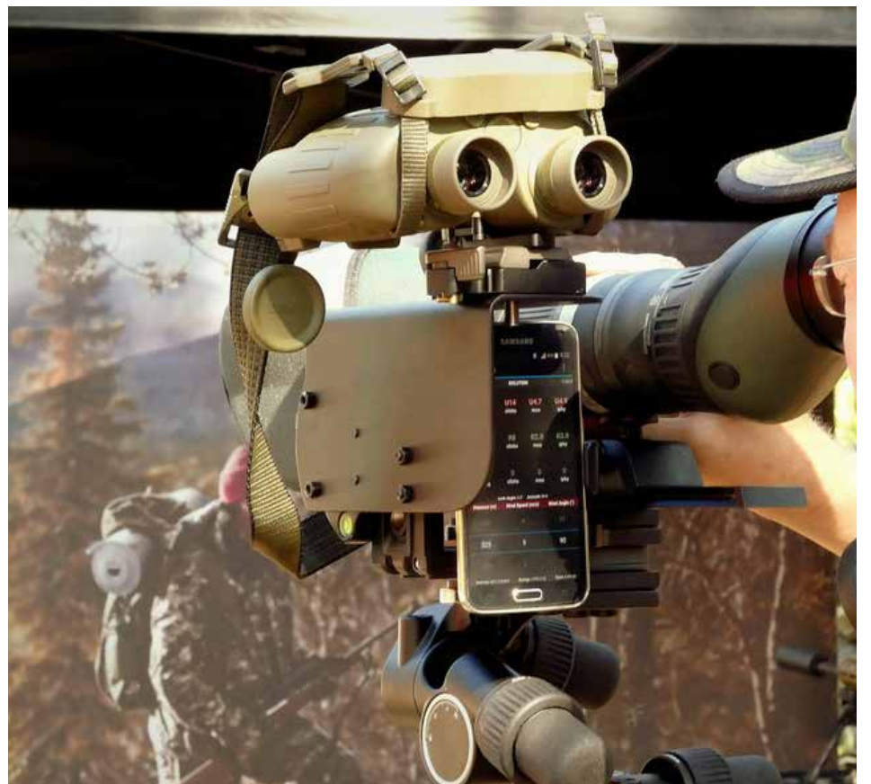
Ballistiikkalaskuri älypuhelinsovelluksena, joka laskee tarvittavat arvot. Tarkka-ampujan on pystyttävä kuitenkin itse tekemään tarvittavat laskutoimitukset. Talvisodassa tarkka-ampujan tavoite oli ampua muutaman sadan metrin päässä oleva vihollinen. Nykyisin suomalaiset tarkka-ampujat ampuvat jopa 1,5 kilometriin saakka.
