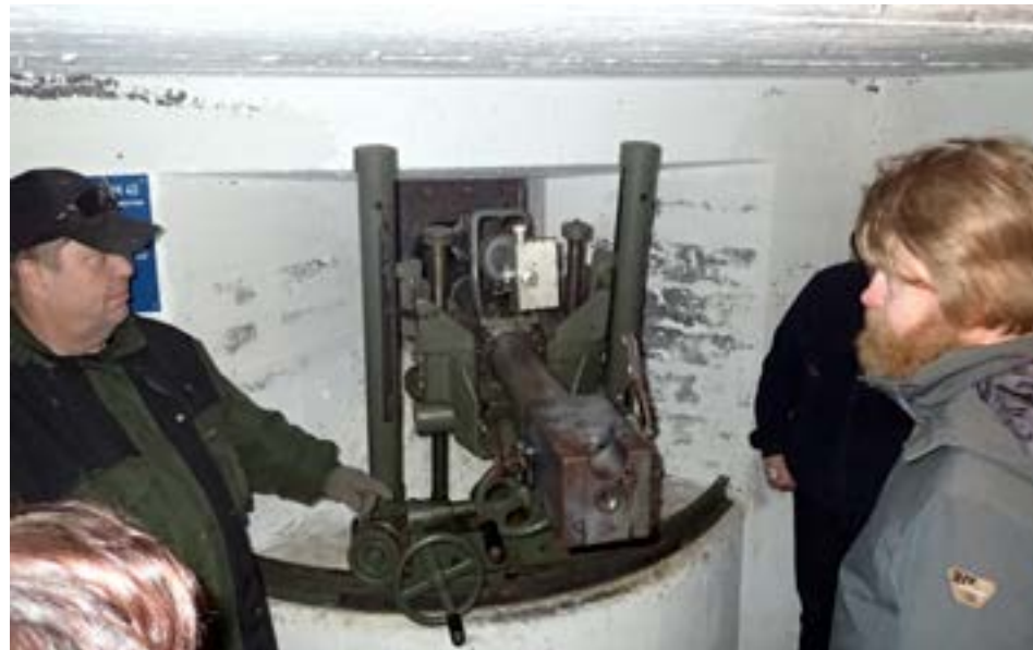
Salpalinjan Miehikkälässä sijaitsevan museobunkkerin aseistusta. Korsutykki M40, kiilalukokoinen panssarintorjuntatykki, kal. 45mm. Tulinopeus 4-6 ls/min, ammuksina panssariammus, panssarikranaatti ja sirpalekранаatti, läpisy 20-50mm.
