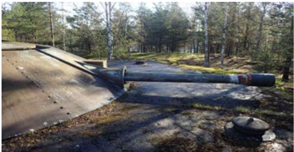
Rankin linnakesaaren 152/50 T (152mm 50 kaliiperin merikanuuna mallia Canet, putki Tampella), oli Suomen Rannikkotykistön pääase 1950-luvulta 1980-luvulle, jolloin 130 TK syrjäytti sen. Kuvan tykin kantama oli 25 km ja käytännön tulinopeus 4-6 ls/min. Täysmiehistö oli 1 aliupseeri ja 12 miestä. Väylätorjuntaan käytettiin pienempikaliiperisia tykkejä.
