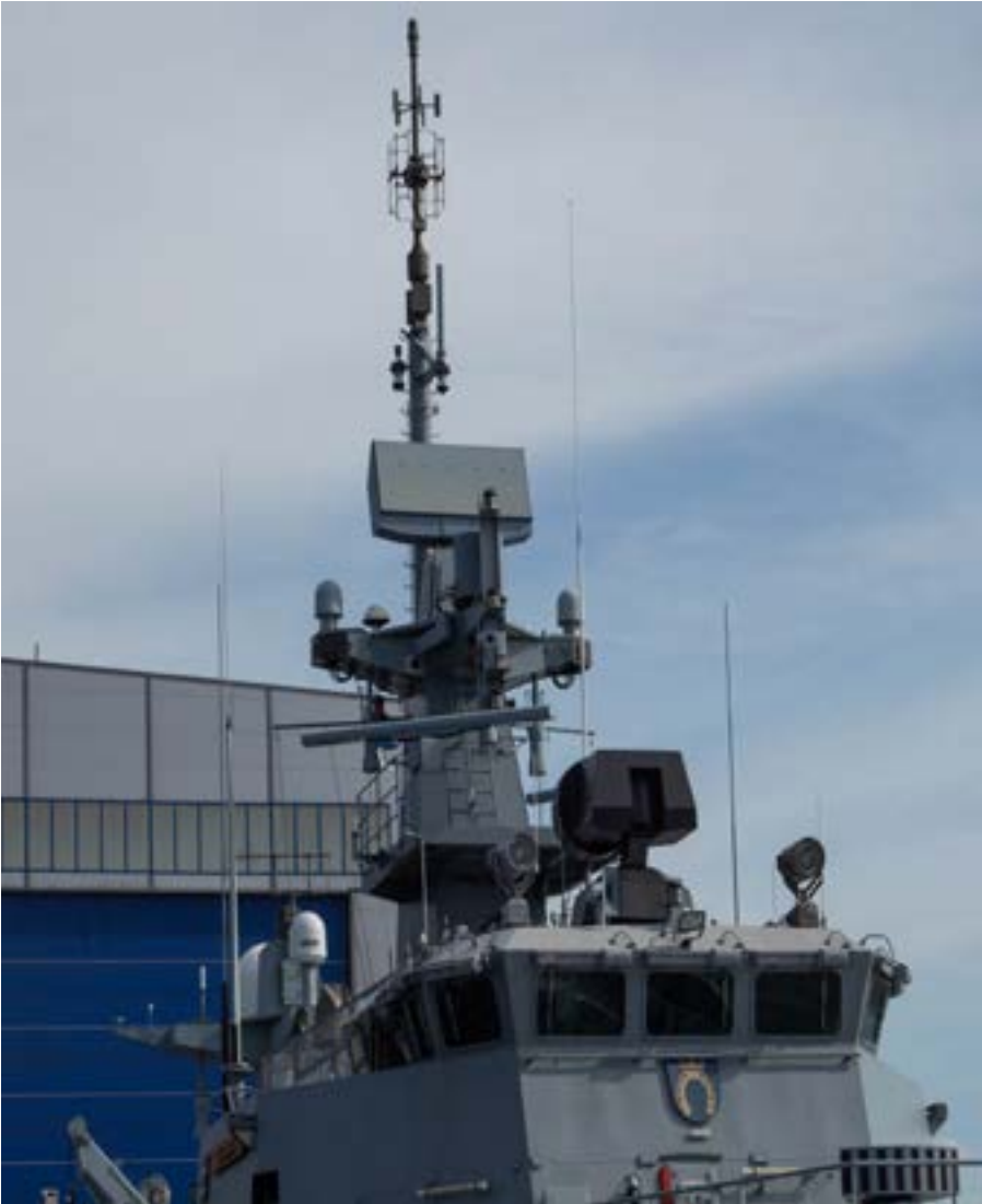
Miinalaiva Uusimaan 28-metrisessä mastossa löytyy niin 3D-valvontatutkaa kuin tulenjohtoseurainta.
