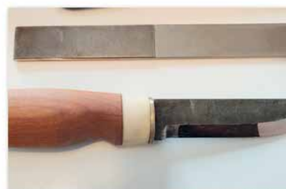
2. Terä tussattu, eli tässä on näön vuoksi tussattu koko teränsivu, että näkee mihin liippa ottaa milläkin kulmalla.
