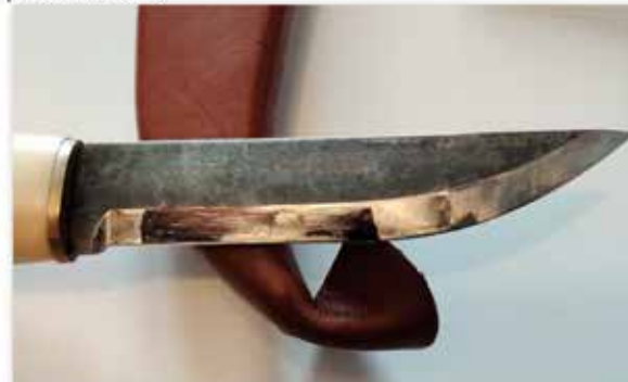
3. Eri kulmat. Terän tyvessä oikea teroituskulma ja muuttuu kärkeä kohti lappeen suuntaiseksi, jolloin lopulta liippa ottaa enää siihen terän sivuun.
