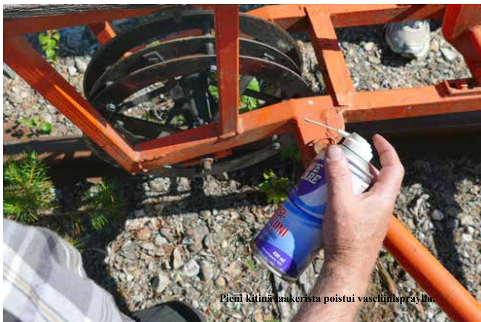
Kolmipyöräresiina kulkee laipallisten teräspyöriensä varassa vakaasti kiskoilla. Välitys on suunniteltu keveäksi ja kitka sileillä kiskoilla on pieni.
