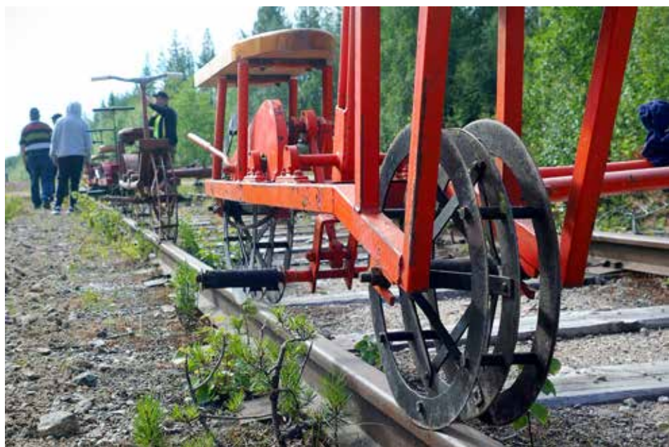
Kolmipyöräresiina kulkee laipallisten teräspyöriensä varassa vakaasti kiskoilla. Välitys on suunniteltu keveäksi ja kitka sileillä kiskoilla on pieni.
