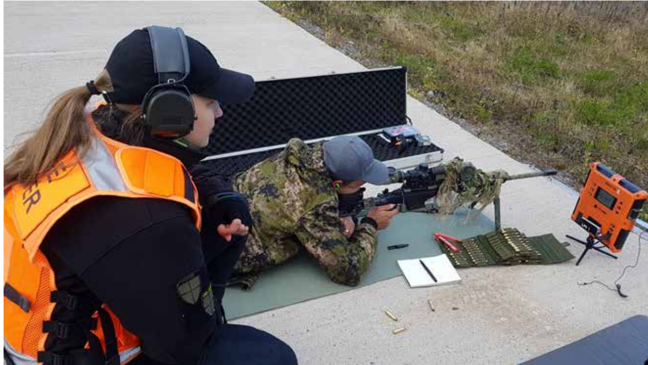
Luodin lähtönopeuden mittaus Doppler-tutkalla. Kuva: Pauli Salo
