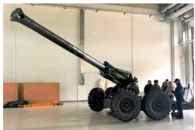
Raskas kanuuna 155 K 83–97, valmistaja Vammass Suomi, kaliiberi 155 mm, kantama 29 km, 6 laukausta/min, paino 10,5 tn, ammuksen paino 43 kg.
