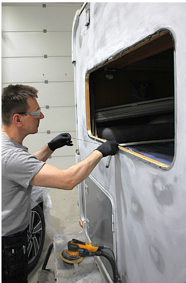
Ammattimies pohjustamassa asuntoauton ikkunan vaihtoa.
