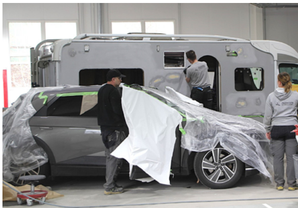
Asuntoauton kylkivauriot on korjattu ja auto on matkalla maalaukseen sekä ikkunoiden ja oven vaihtoon.
