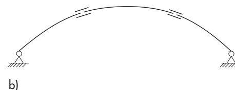
Kuva 10.3 Kaarirakenteiden jatkosten sopiva sijoitus. a) Niveljatkos b) Momenttijäykkä jatkos
