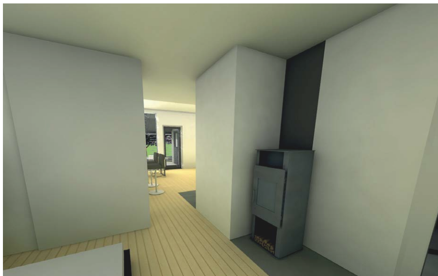
Savupiippuvaraaja on koteloitavissa eikä vaadi teknistä tilaa. Kylkeen kytetään myös vesikiertoinen pellettikamiina. Talomalli: Flow, www.baulog.fi . RenderLights-virtuaalimalli ja suunnittelu: Ari Käsäkoski.
