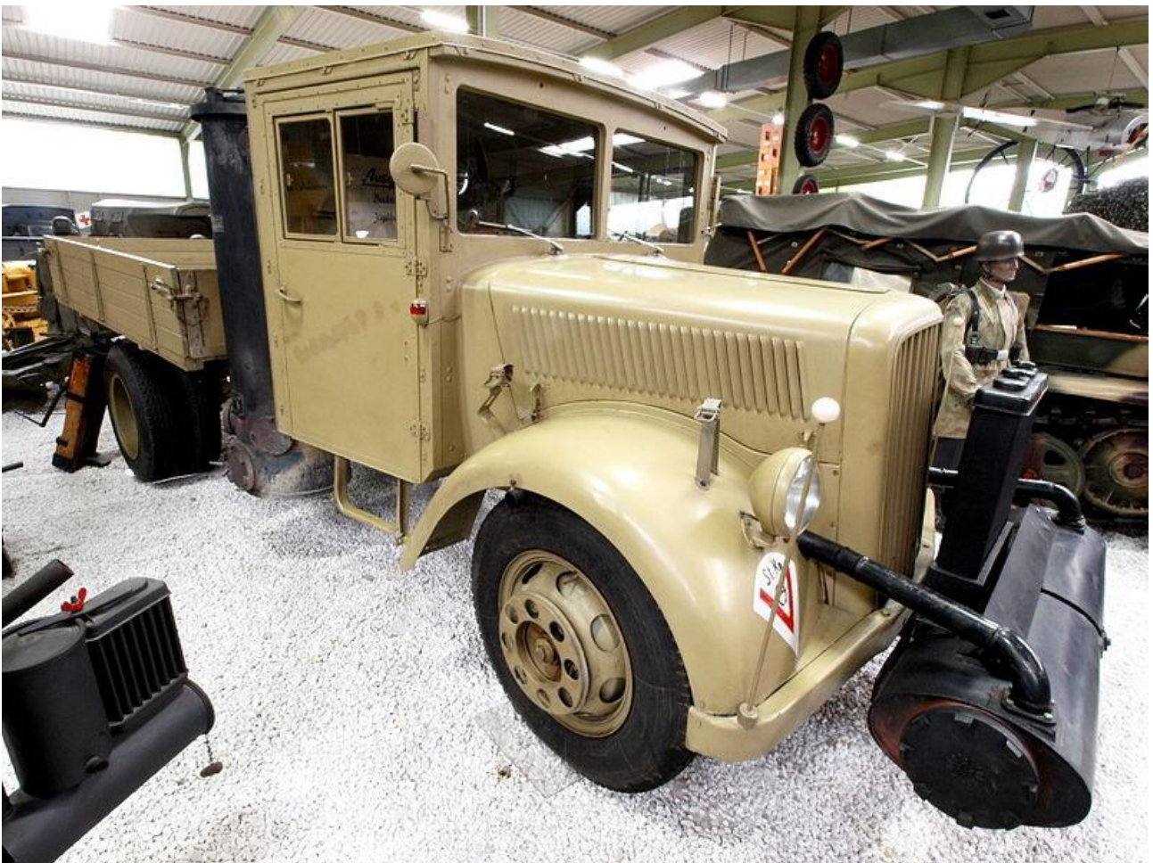
Mercedeksen Opelin lisenssillä valmistama Opel Blitz. Mercedeksen mallinimikkeellä L701. Kulmikas puuhytti ja puukaasutinjärjestelmä. Karu ulkoasu kätkee sisäänsä sodan pakottamaa tarkoituksenmukaisuutta.
