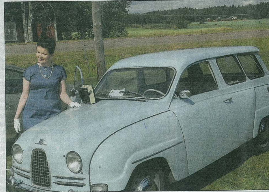
Helsinkiläisellä Tanja Virtanen-Lepällä oli ajokkinaan "aikansa tila-auto". Vuoden -62 Saab oli tarkoitettu seitsemälle, ja siinä on kaksitahtimoottori ja 32 hevosvoimaa.
