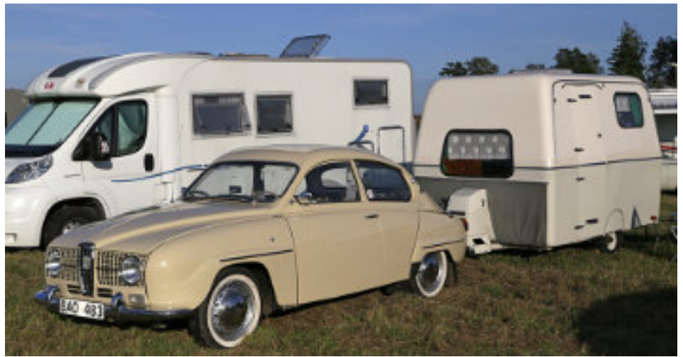
Lasikuituinen Saabo-vaunu suunniteltiin erittäin keveäksi vedettäväksi sen valmistajan eli Saabin automalleja ajatellen. Saaboja syntyi vuosina 1964-1968 kaiken kaikkiaan 390 kappaletta.
