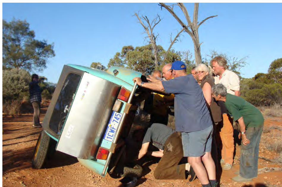
Olkatapin vaihto, Sätkä nostettu kyljelleen.
