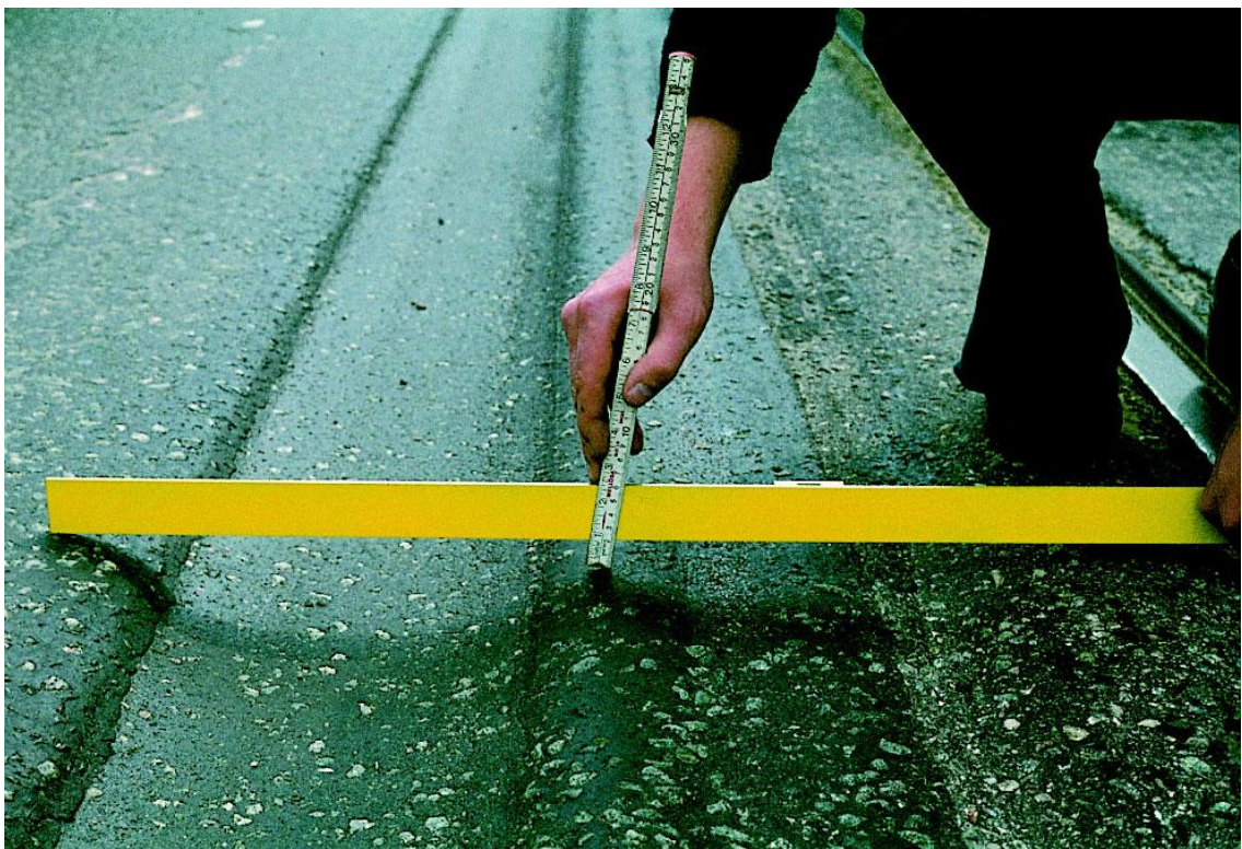
Kuva 4. Ajoura ja urasyvyyden mittaus oikolaudalla. Kuvan mittaustapa ei ole standardinmukainen. (Garba 2002, s. 12)
