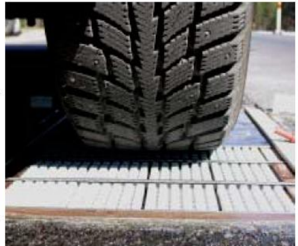
Kuva 21. VTT:n yliajokokeen graniitista valmistettu kulutuskoekappale (Unhola 2004, s. 14)
