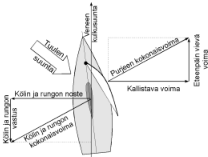
Kuva 2. Purjeverne luovilla. Vene kulkee kylkimyrryä, kölin ja rungon noste on yhtä suuri kuin purjeen kallistava voima ja purjeen eteenpäin vievä voima yhtä suuri kuin kölin ja rungon vastus. Purjeen kokonaisvoiman suunta määräytyy kuten kölinkin, eli se on tilkan ilmanvastuksen ja nosteen resultantti (jätetty piirroksen merkitsemättä samoin kuin rungon ilmanvastuskin).
