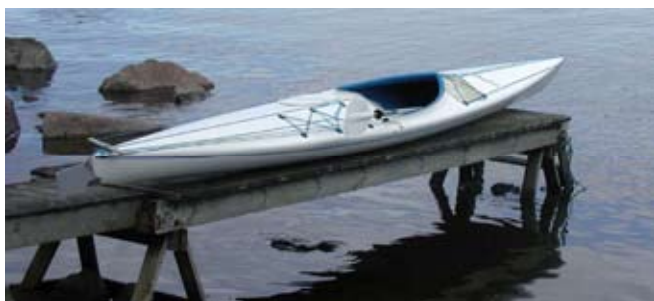
Kuva 5. VKV veistämön "Anita" mökkirannassa. Istuma-aukon pituus on pitkäraajaisellekin riittävä ja sen sisäreuna sopivasti pyöristetty niin, että 23 kilon kajakin kantaa mukavasti olkapäällä. Peräsin on samaa taakse taivutavaa tyyppiä kuin kuvan 1 omatekoisessa kaksikossakin. Loivaa harjakattoa muistuttava kannen profiili tuo mieleen varhaisten kajakkien keveät kangaskannet. Linjat ovatkin vuodelta 1930. Istuma-aukon edessä olevan kumikyöden alle saa kätevästi merikortin ja takakannelle tyhjän melakellukkeen. Muu tavara mahtuu sisälle vedenpitäviin osastoihin.
