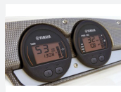
3. LAN-mittaristo - kierrosluku - trimmaustaso - varoitukset - veneen nopeus - käytettävissä oleva polttoaine - polttoaineen kulutus
