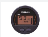
2. LAN-mittari - kierrosluku - trimmaustaso - varoitukset
