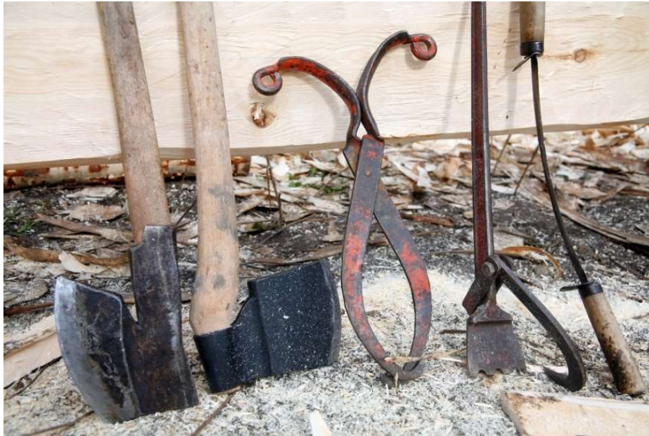
Kuva 1. Kengittäjän työkaluja: halkaisu- eli egyptinparrukirves, piilukirves, tukkiraudat, vänkäri ja parkkirauta.
