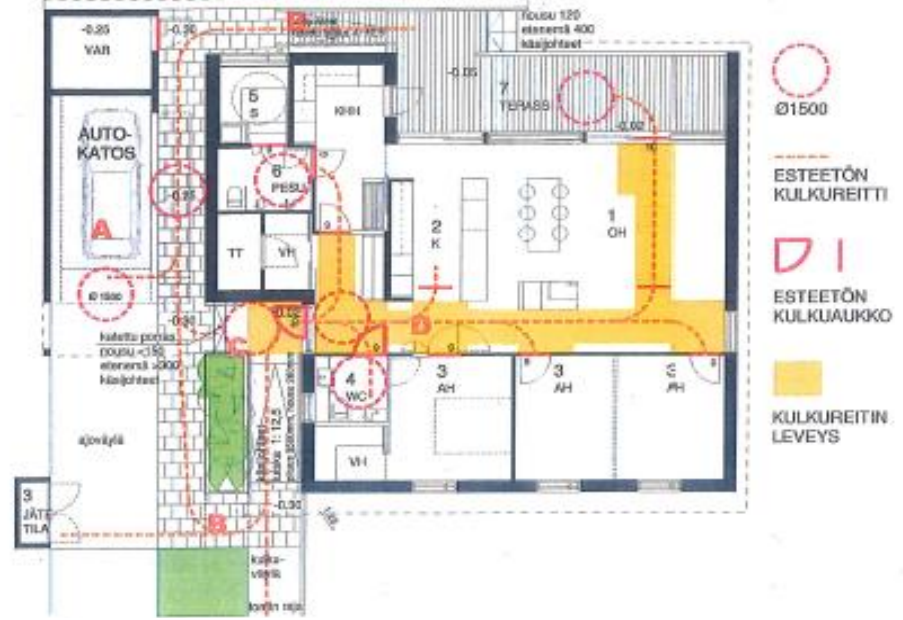
Piirroksen esimerkissä pientalon esteetön sisäänkäynti on järjestetty autokatoksen kautta, jolloin 8 %:n kaltevuus järjestely luontevasti.
