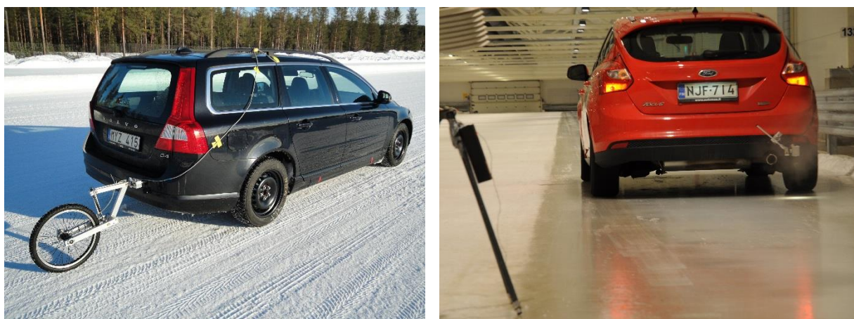
Figur 7. Testfordon för broms- och accelerationstester med personbil. Till vänster Volvo V70 för snö- och istester på Arctic Falls, och till höger en Ford Focus för istester på TestWorld i Finland. Foto Carl Södergren (vänster) och Mattias Hjort (höger), VTI.
