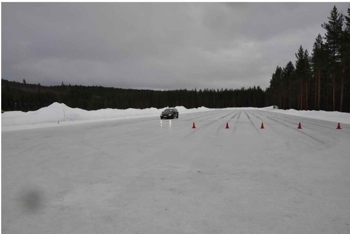
Figur 11. Isbanan (opreparerad) med fem parallella spår i varje riktning, markerade med koner. Foto Mattias Hjort, VTI.
