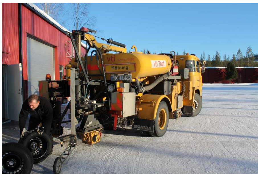
Figur 6. VTI:s mobila däckfriktionsmätare, BV12. Foto Mikael Bladlund, VTI.
