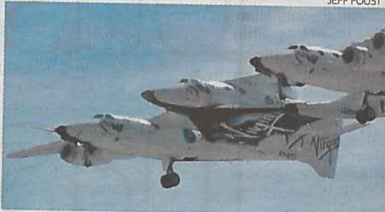
Sorjasiipinen lentokone White Knight 2 kuljettaa mahansa alla Space Ship Two -alusta, jonka kyydissä Vesa Heilala pääsee avaruuteen.
