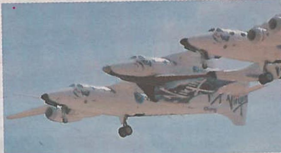
Sorjaslipinen lentokone White Knight 2 kuljettaa mahansa alla Space Ship Two-alusta, jonka kyydissä Vesa Hellala pääsee avaruuteen.
