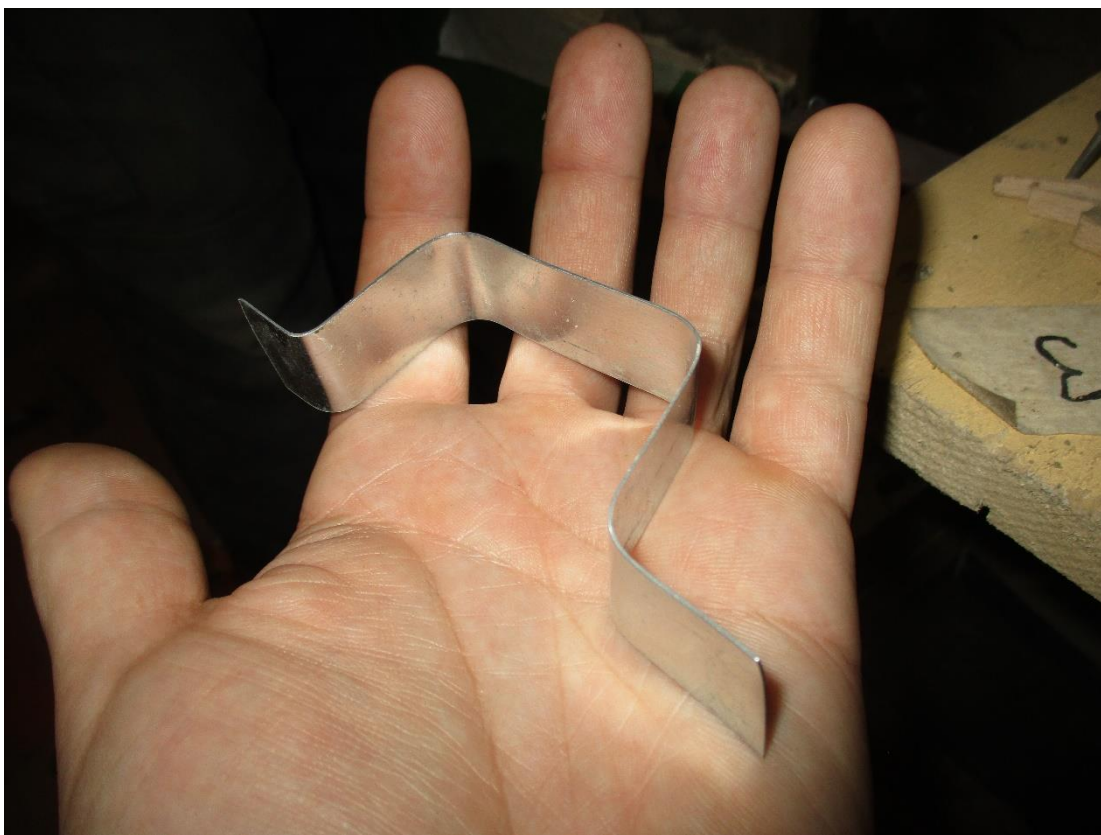
Kuva 6 Klemmari on taiteltu peltiliuska, joka varmistaa kaakelien paikoillaan pysymisen.
