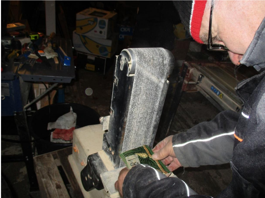
Kuva 19 Pienemmät työstöt tehdään nauhahiomakoneella, jossa on lasin hiomiseen tarkoitettu hiomapaperi.
