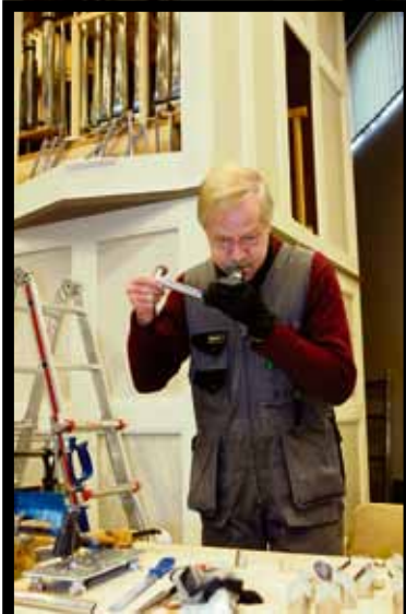
Taisto Leskinen tekee urkuja 51. vuotta, sillä hän aloitti jo 15-vuotiaana. Hän testaa lyijyputken juotossauman pitävyyttä.
