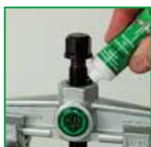
Wir empfehlen die Verwendung von KUKKO Spezialfett für Druckspindeln (Art.-No.: 699999) oder von KUKKO Bio-Multi-Öl (Art.-No.: 699990).
