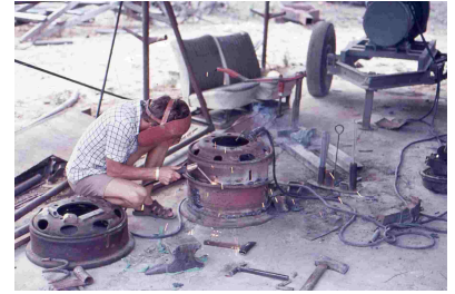
Mikko hitsaamassa saunan-kiuasta vanhoista kuorma-auton vanteista Namibiassa.
