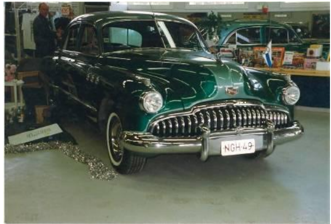
Buick Super 4D DynaFlow, vm. 1949 Museokatsastettu, 2-värinen, V-8, 5,7 l, 115 HV, 145 km/h, 1900 kg, 5,46 m pitkä, 2,03 m leveä
