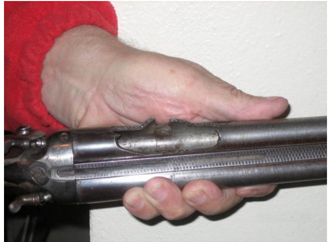
Kaksipiippuisen haulikon vasemmanpuoleisen piipun patruunapesä räjähti kokonaan auki.
