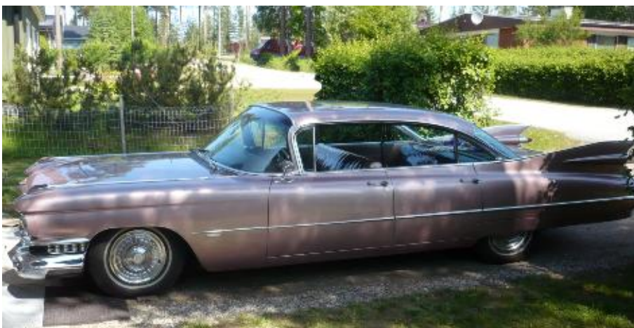
Cadillac De Ville Sixty Two 4D HT, vm 1959, museokatsastettu v. 1987, väri: persianhiekkä, paino 2200 kg, moott. 6,4 l, 325 HV, V8, pituus: 5,71 m, leveys: 2.03 m, rek 6:lle, huippunopeus: 195 km/h
